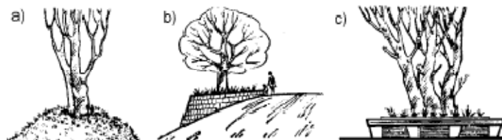
a) pozostawiony ścięty stożek z gruntu, ochraniający korzenie drzewa
