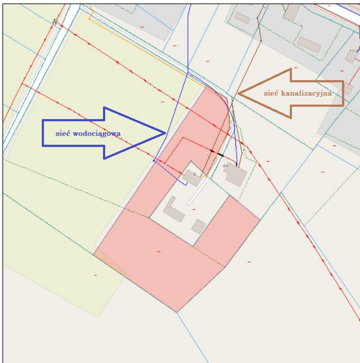
Rys. 9.2. Lokalizacja sieci wodociągowej (kolor granatowy) i sieci i urządzeń kanalizacyjnych (kolor brązowy). Kolor czerwony – obszar opracowania. Źródło: opracowanie własne na podstawie http://ostroda.geoportal2.pl/map/
